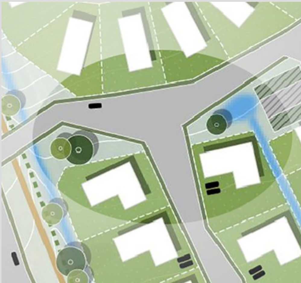
Figur 2. Boligveje skal indrettes med 'knæk'/sving og hvor vejen møder andre veje, skal der ske en udvidelse af vejbredderne og etableres beplantning i form af træer i bede.
