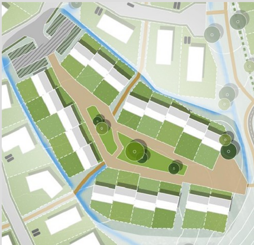
Figur 9. Princip for indretning af tæt-lav bebyggelse, hvor boligerne orienterer sig mod bolig-gaderne og har primær indgang herfra.
